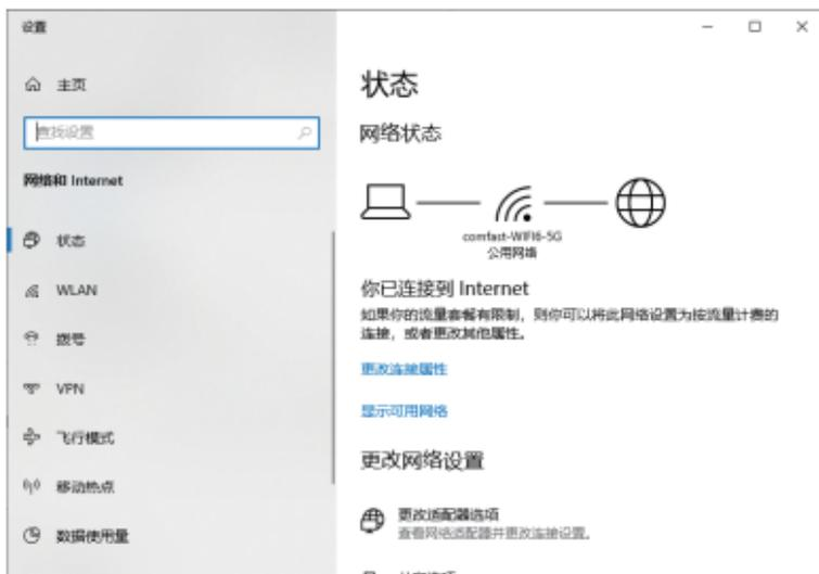
4-2 点击“WLAN”选项，然后再点击显示已连接的无线，便可查看无线的当前IP，MAC地址，网关，驱动版本等。
