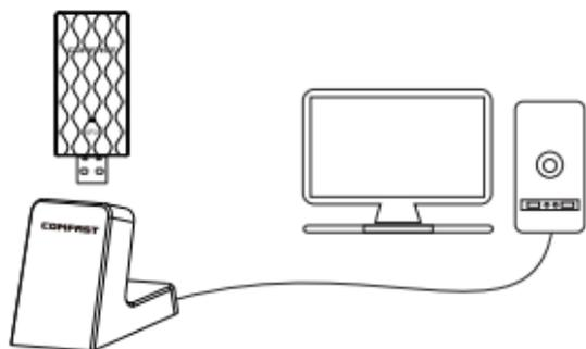
注意：台式机使用时，建议使用USB延长线底座连接电脑机箱后面接口（大部分台式电脑前面USB接口供电不足或不可使用），延长到桌面使用，效果更好！
