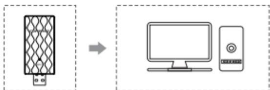
2.通过USB延长线底座连接电脑USB接口。（USB延长底座需另购）
